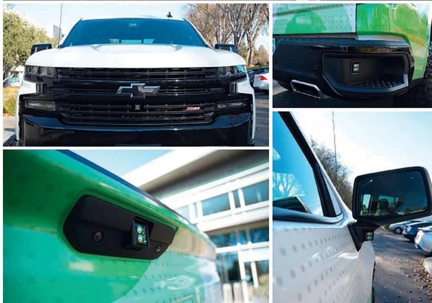
**Bild 2: Mögliche Platzierungsorte für gerichtete Lidar-Sensoren, z. B. am Kühlergrill, an den Seitenspiegeln, an der Heckklappe und an der hinteren Stoßstange.** © Cepton
